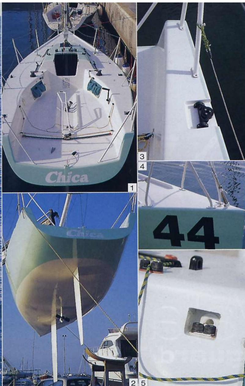
e la disposizione delle manovre riflette un lungo lavoro di ricerca di pulizia del piano di calpestio e di ergonomia delle manovre; i ritorni delle scotte dello spinnaker scorrono sottocoperta, così come i barber spi e il paranco del pate-razzo. Grazie al pozzetto di grandi dimensioni e alla disposizione delle manovre, cinque persone si muovono con comodità.
